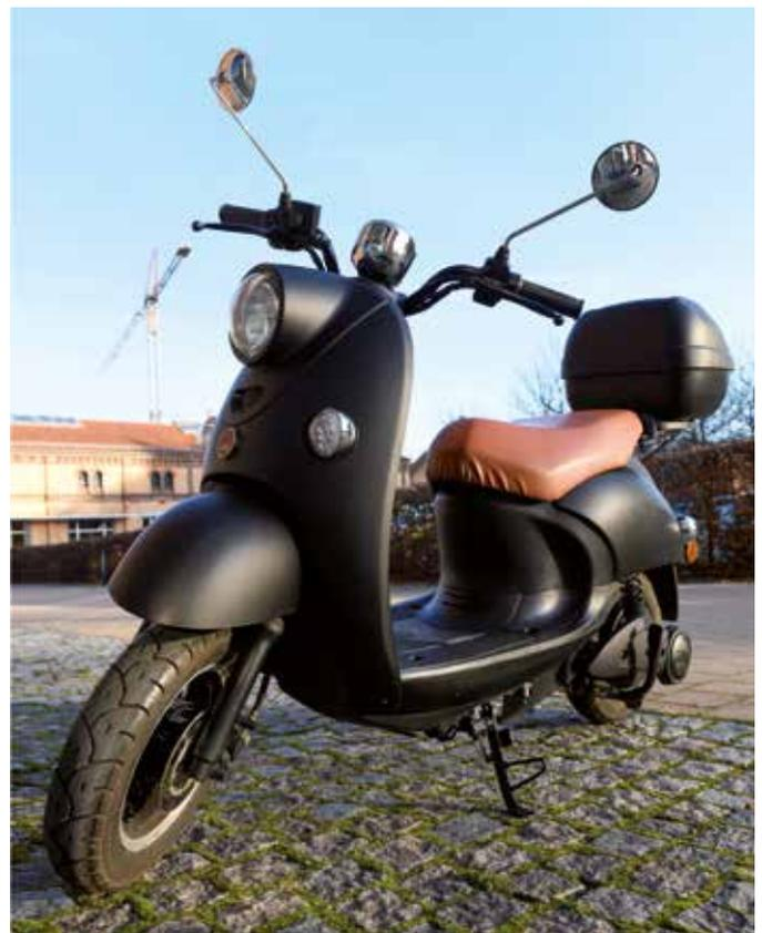
bei meinem „unu“ der Motor heftig und aus 50 Stundenkilometern werden nur noch recht lahme 38. Hauptsache aber, man kommt am Ende rollend zu Hause an. Der Ladevorgang dauert rund fünf Stunden, nach zwei Stunden ist der Akku zu 70 Prozent gefüllt. Unter dem Sitz findet auch noch ein zweiter Akku Platz. Den habe ich dabei für längere Strecken.
